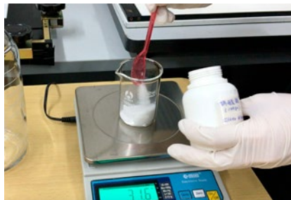
② 使用蒸餾水調製硝酸鹽溶液
