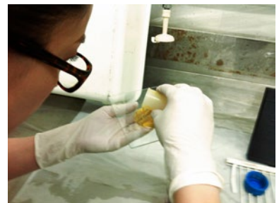
③ 預備製作玻璃底片，把火棉膠薄薄地塗在玻璃上
