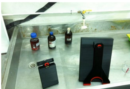
④ 然後把玻璃片放進載有硝酸銀溶液的黑盒內，浸泡約一分鐘
